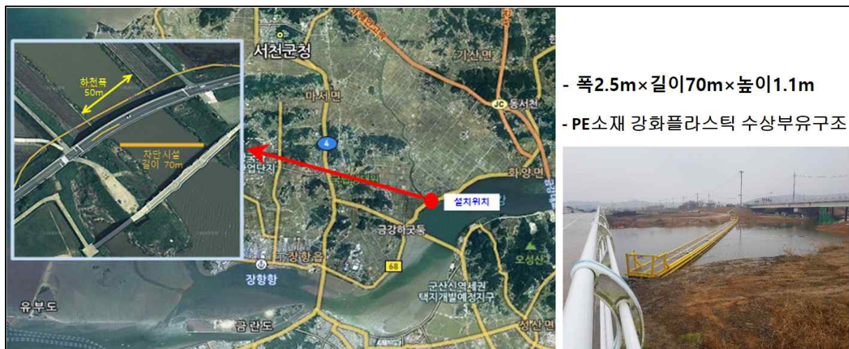
[그림 4-74] 하천 부유쓰레기 차단시설 설치사례(서천군 길산천)
