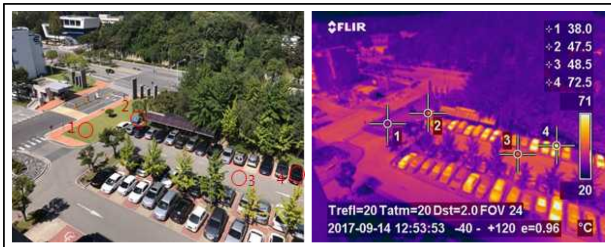
[그림 22] 태양광모듈과 주변 시설물 온도 측정
