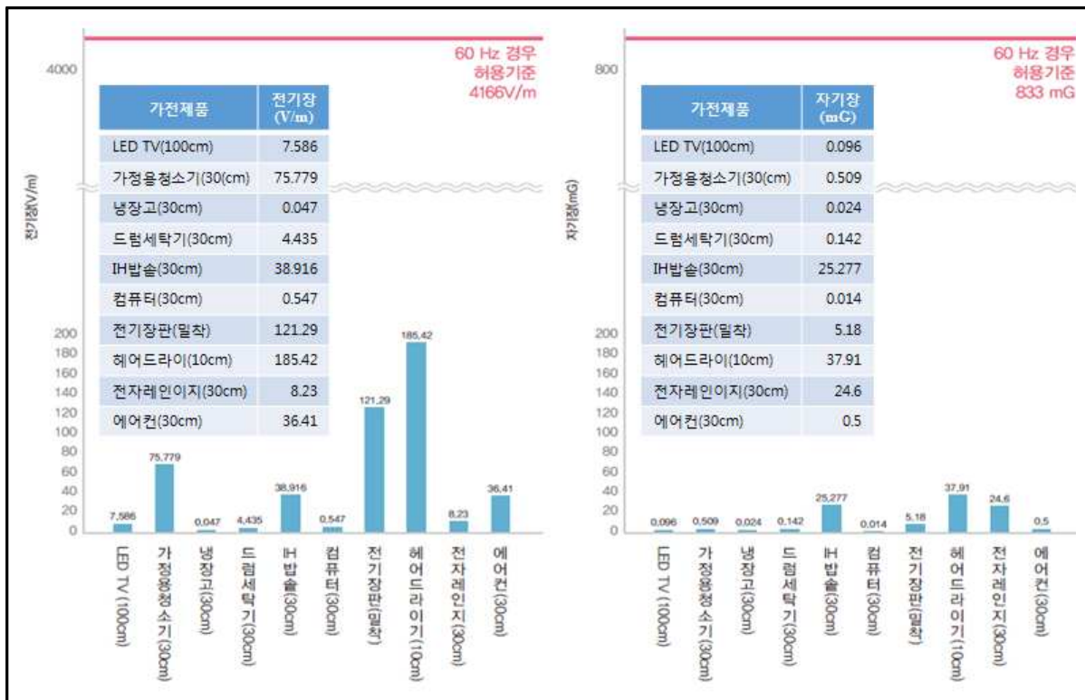
[그림 20] 생활속 가전제품 전자파(왼쪽:전기장, 오른쪽:자기장) 밀착 측정 가이드북
