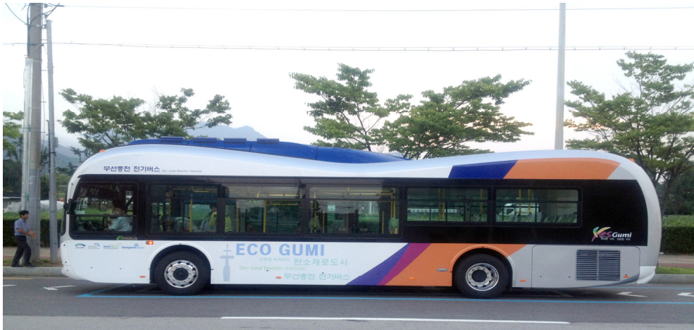
<그림-30> 구미시에서 운영 중인 무선 충전형 전기버스 26)
