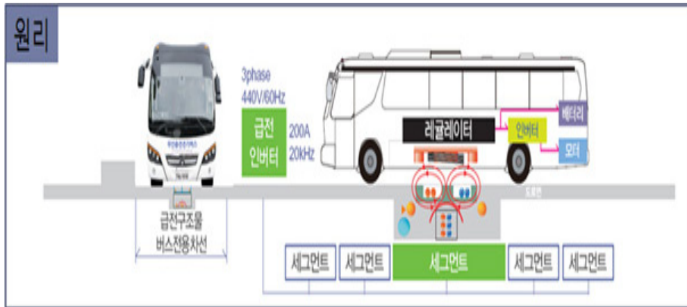
<그림-29> 무선 충전형 전기 버스 원리 25)
